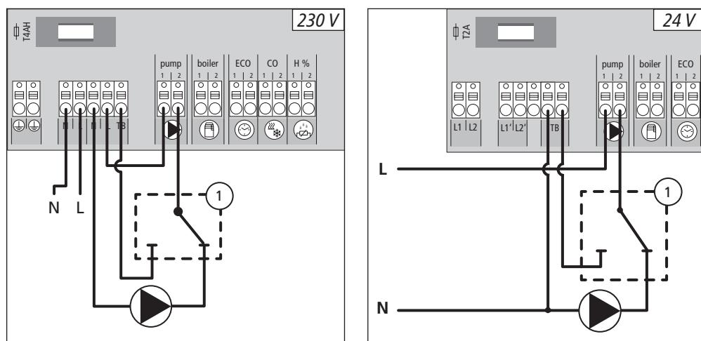
Podłączenie ogranicznika temperatury, dostarczonego przez użytkownika (1). Wyłącza on pompę i włącza wejście ograniczenia temperatury, gdy rozpoznane zostaną zbyt wysokie wartości temperatury dopływu czynnika w ogrzewaniu podłogowym. Po włączeniu ogranicznika temperatury, listwa elektryczna zamyka automatycznie wszystkie napędy.
