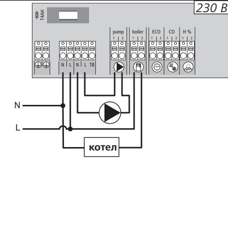
Подключение через разъем Boiler (котел) позволяет управлять генератором тепла. Кроме того возможно непосредственное подключение питания и управление насосом.
