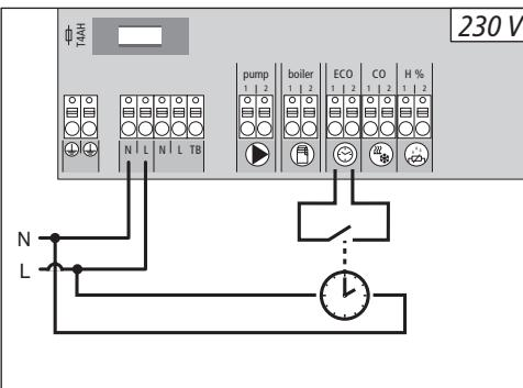
Basisstationen er udstyret med en ECO-indgang for tilslutning af en ekstern timer, hvis det interne ur på rumtermostaten Funk Display ikke skal bruges. Ved aktivering af indgangen via timeren kobles varmezonerne til natdrift.
