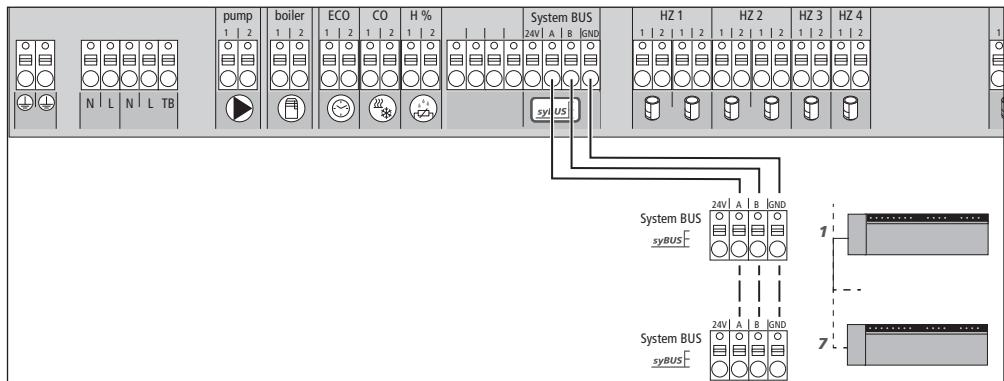
För utbytet av globala systemparametrar kan max. sju basstationer kopplas ihop med varandra över system bussen (syBUS). Efter sammankopplingen måste basstationerna paras med varandra - se kapitel 4.2. Vid en kabeldiameter <6 mm skall dragavlastningen ske genom kundens försorg.
