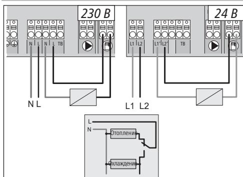
При отсутствии доступного внешнего сигнала Change Over (CO) можно воспользоваться внутренней функцией переключения клеммной колодки, служащей для переключения всей системы между режимами отопления и охлаждения. В этом случае переключение выполняется через реле, используемое клеммной колодкой.
