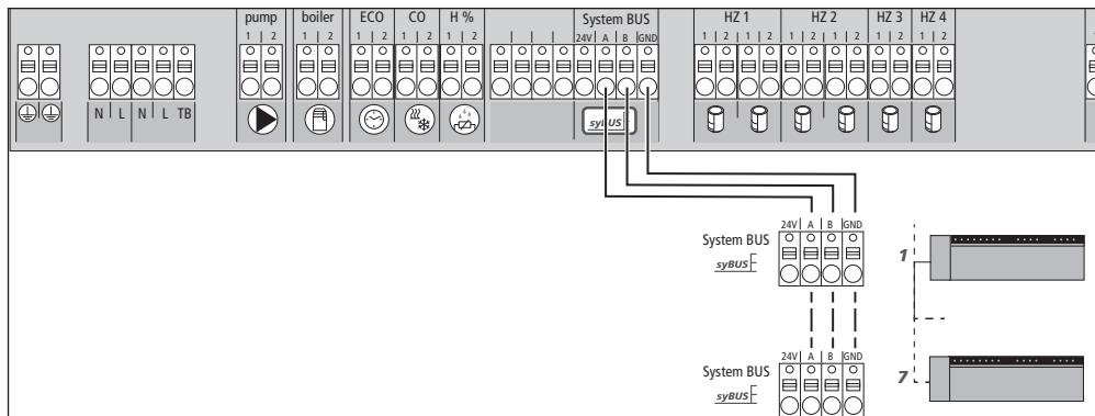
W celu wymiany globalnych parametrów systemu możliwe jest połączenie max. siedmiu stacji bazowych za pośrednictwem systemu BUS (syBUS). Po wykonaniu okablowania należy sparować stacje bazowe - patrz rozdział 4.2. W przypadku średnicy przewodu <6 mm należy przewidzieć instalację systemu odciążenia.
