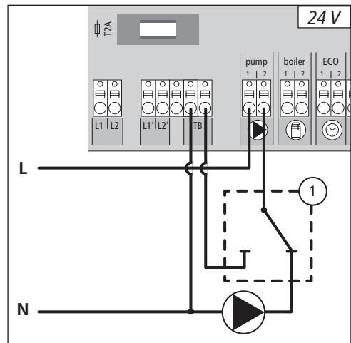
Anslut ett temperaturskydd (1), medföljer inte. Detta skydd kopplar ur pumpen och kopplar ingång TB, när för höga ledtemperaturer upptäcks i golvvärmen. Om TB-ingången kopplas startar basstationen automatiskt alla drivenheter.
