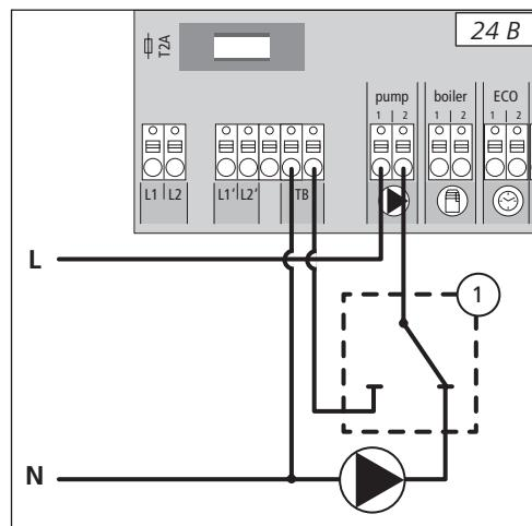
Подключение предоставляемого заказчиком ограничителя температуры (1). Он отключает насос и включает вход ограничителя температуры, если будет обнаружено превышение температуры теплоносителя для панельного отопления. После включения ограничителя температуры, клеммная колодка автоматически закрывает все сервоприводы.
