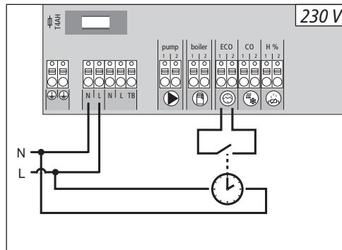
Basstationen är utrustad med en ECO-ingång för anslutning av ett externt tidur, när den interna klockan i rumskontrollens radiodisplay inte ska användas. Vid aktivering av ingången med hjälp av tiduret ställs uppvarmningszonerna in på nattdrift.
