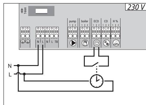
Listwa elektryczna jest wyposażona w wejście ECO służące do podłączenia zewnętrznego zegara sterującego do wykorzystania w przypadkach, kiedy nie należy używać wewnętrznego zegara na wyświetlaczu termostatu bezprzewodowego. Po aktywacji wejścia przez zegar sterujący strefy grzania są przełączane na tryb nocny.
