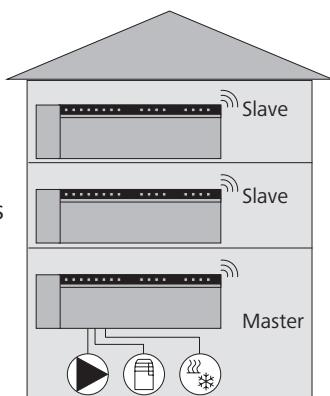
**Anvisning:** Basstationen som komponenterna är anslutna till måste konfigureras som master. Ytterligare basstationer kan endast paras med mastern.
