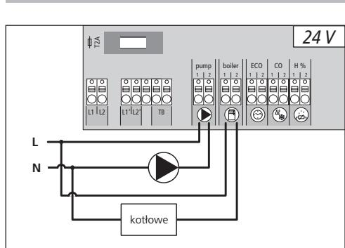
Złącze Boiler (kocioł) umożliwia sterowanie generatorem ciepła. Ponadto możliwe jest bezpośrednie zasilanie i sterowanie pompą.
