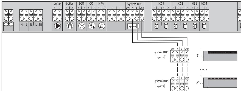
Til udveksling af globale systemparametre kan maks. syv basisstationer forbindes med hinanden via system BUS (syBUS). Efter trådføringen skal basisstationerne parres med hinanden - se kapitel 4.2. Ved en ledningsdiameter <6 mm skal trækaflastningen konfigureres ved byggeriet.
