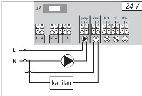
Boilerin (kattilan) liitintä mahdollistaa yhden lämmöntuottajan hallinnan. Lisäksi voidaan hallita suoraan yhtä pumppua.
