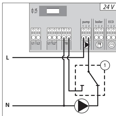
Tiloissa valmiina olevan lämpötilarajoittimen (1) kytkeminen. Rajoitin sammuttaa pumpun ja kytkee TB-tulon, kun lattialämmittyksessä havaitaan liian korkeita lämpötiloja. Kun TB-tulo on kytketty, sulkee perusyksikkö kaikki käyttölaitteet.
