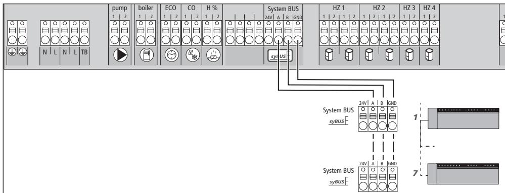
Для обмена глобальными системными параметрами через системную шину (syBUS) можно соединить друг с другом макс. семь базовых модулей. После электромонтажа базовые модули следует соединить попарно - см. главу 4.2. При диаметре провода <6 мм заказчик должен предусмотреть зажим для разгрузки провода от натяжения.
