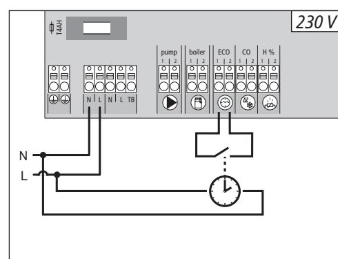
Jos ulkoista vaihtosignaalia ei ole käytettävissä, voidaan käyttää perusyksikön sisäistä pilottitoimintoa vaihtamaan kokonaislaitteisto lämmityksen ja jäähdystyksen käyttötilojen välillä. Tällöin käytetään perusyksikön vaihtorelettä.
