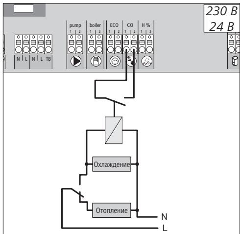
Если используется внешний переключающий сигнал Change Over (CO), то вся система переключается между режимами отопления/охлаждения согласно сигналу.
