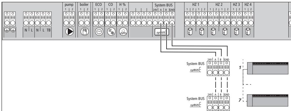
Yleisten järjestelmäparametrien synkronoimista varten voidaan kytkeä keskenään jopa seitsemän perusasemaa järjestelmävällyn (syBUS) kautta. Johtojen kytkemisen jälkeen perusasemat täytyy parittaa, katso luku 4.2. Jos johtimen halkaisija on <6 mm, on johto varustettava vetokevennyksellä.
