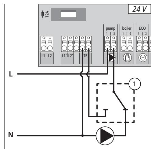
Tilslutning af en temperaturbegrænsner (1). Den kobler pumpen fra og skifter til indgangen TB, hvis der registreres for høje fremløbstemperaturer i gulvvarmen. Hvis TB-indgangen tilkobles, styrer basisstationen automatisk alle drev.
