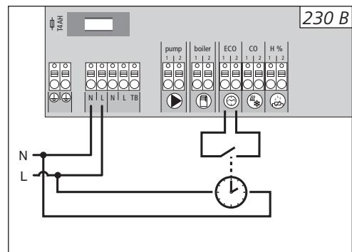
Клеммная колодка имеет вход ECO, служащий для подключения внешнего таймера в случаях, когда не будут использоваться внутренние часы на дисплее беспроводного терmostата. Если вход активируется по таймеру, зоны отопления переключаются на ночной режим.
