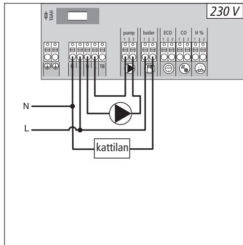
Boilerin (kattilan) liitintä mahdollistaa yhden lämmöntuottajan hallinnan. Lisäksi voidaan hallita ja syöttää suoraan yhtä pumppua.
