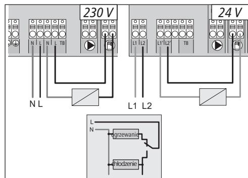
W przypadku braku dostępnego zewnętrznego sygnału Change Over (CO) można użyć wewnętrznej funkcji przełączania listwy elektrycznej służącej do przełączania całej instalacji pomiędzy trybami grzania i chłodzenia. W tym przypadku stosuje się przekaźnik wykorzystywany przez listwę elektryczną do przełączania.
