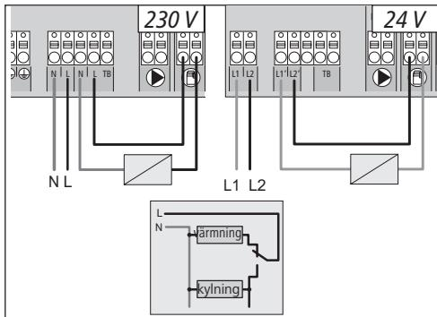
Om ingen extern Change Over-signal står till förfogande, kan den interna pilotfunktionen på basstationen användas för omkoppling av hela anläggningen mellan driftlägena värmning och kylnings. Då används ett relä som basstationen utnyttjar för omkoppling.
