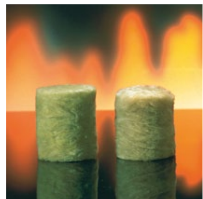
Vasemmalla kivivillanäyte ennen palamattomuustestiä, oikealla sama näyte testin jälkeen.
