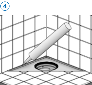
Raam kinnitatakse ja kaas paigutatakse raami sisse.
